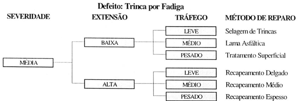
FIGURA 8 - Exemplo de “árvore de decisão” para seleção de métodos de reparos para cada tipo de deterioração (CHEN et al., 1993).
