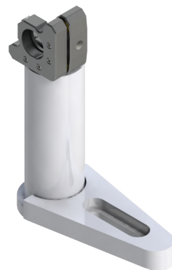
Figura 4: Projeto mecânico do suporte de fixação dos componentes ópticos
