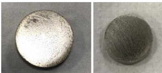
Figura 28 - Antes e depois amostra depositada na solução H (Duplicata 1)
