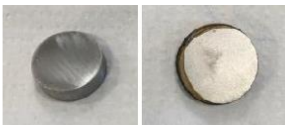
Figura 16 - Antes e depois amostra depositada na solução A (Duplicata 2)
