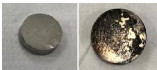
Figura 34 - Antes e depois amostra depositada na solução K (Duplicata 2)
