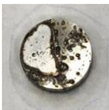
Figura 36 - Amostra depositada na solução L após a ação corrosiva
