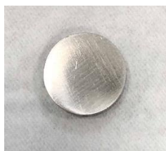
Figura 2 - Amostra padrão de ferro metálico antes da imersão em solução
