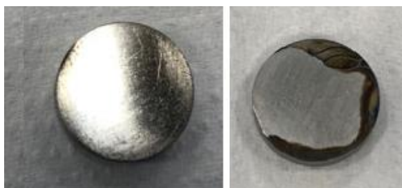
Figura 22 - Antes e depois amostra depositada na Solução D (Duplicata 2)
