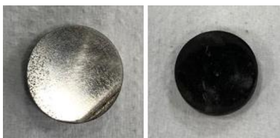
Figura 18 - Antes e depois amostra depositada na solução B (Duplicata 2)
