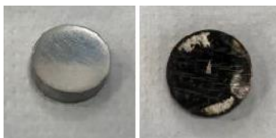
Figura 27 - Antes e depois amostra depositada na solução G (Duplicata 2)
