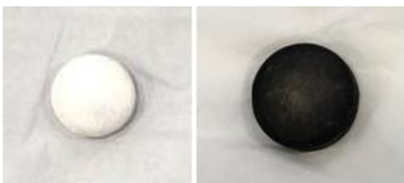
Figura 21 - Antes e depois amostra depositada na solução D (Duplicata 1)
