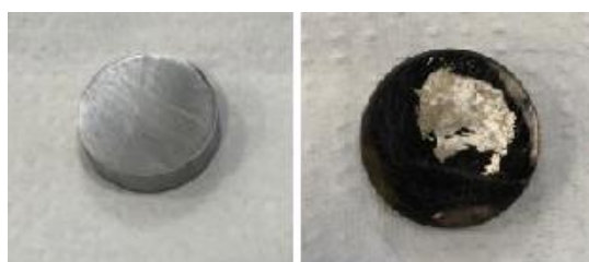
Figura 27 - Antes e depois amostra depositada na solução G (Duplicata 2)
