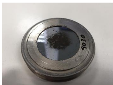
Figura 8 - produto de corrosão formado raspado
