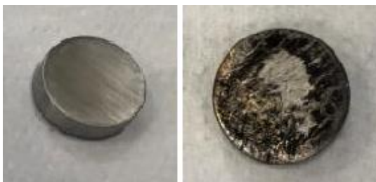
Figura 34 - Antes e depois amostra depositada na solução K (Duplicata 2)
