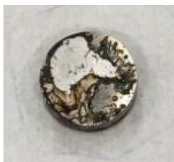
Figura 35 – Amostra depositada na solução L após a ação corrosiva
