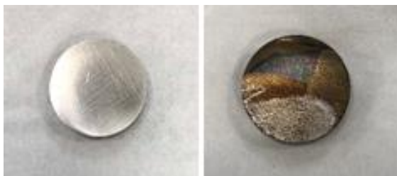
Figura 13 – Antes e depois amostra depositada na solução A (Duplicata 1)
