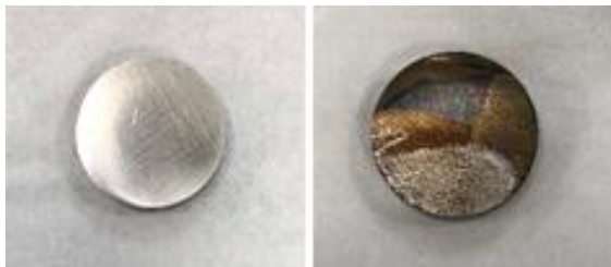
Figura 16 - Antes e depois amostra depositada na solução A (Duplicata 2)
