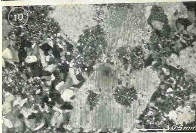
Foto 9 — Veia de calcedonia, bandeada com siderita. Siderita também com fraturas. Luz transmitida, N+.
