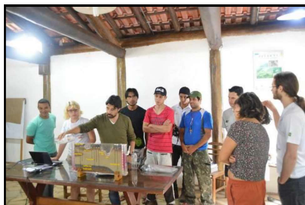
Figura 6 – Demonstração da migração de contaminantes e do fluxo d'água subterrânea a partir de modelo analógico tipo "caixa de areia" (Fonte: GGEO).
