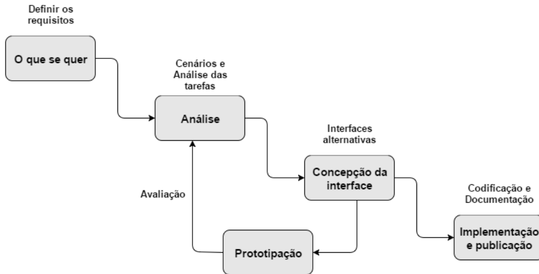
Figura 1 – Representação do Processo UCD proposto por Dix et al. (2003).
