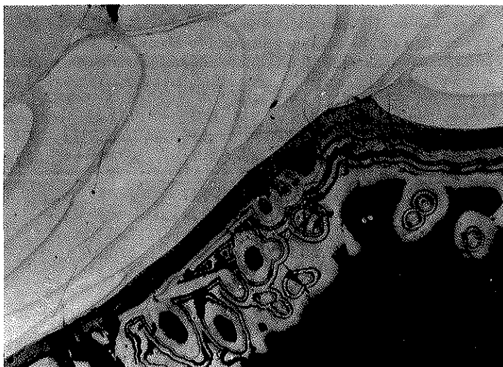
Foto 2 — Fotomicrografia de seção polida. Deposição de material preenchendo cavidades. As camadas coloformes, cinza-clara, são formadas por criptomelana microcristalina. As concreções, cinza-escuras, são de goethita. (Aumento 60 vezes)
