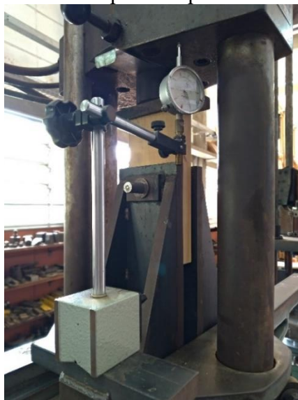
Figura 4 – Ensaio de embutimento para a espécie Goiabão e diâmetro de 16 mm
