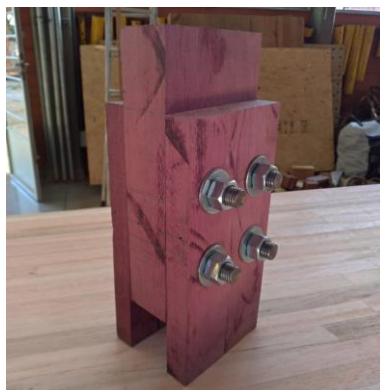
Figura 3 – Protótipo da ligação de Roxinho - parafusos de 16 mm com porcas e arruelas
