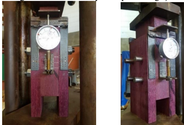
Figura 4 – Ensaio de protótipos da ligação
