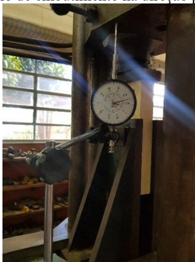
Figura 1 – Ensaio de embutimento na direção paralela às fibras
