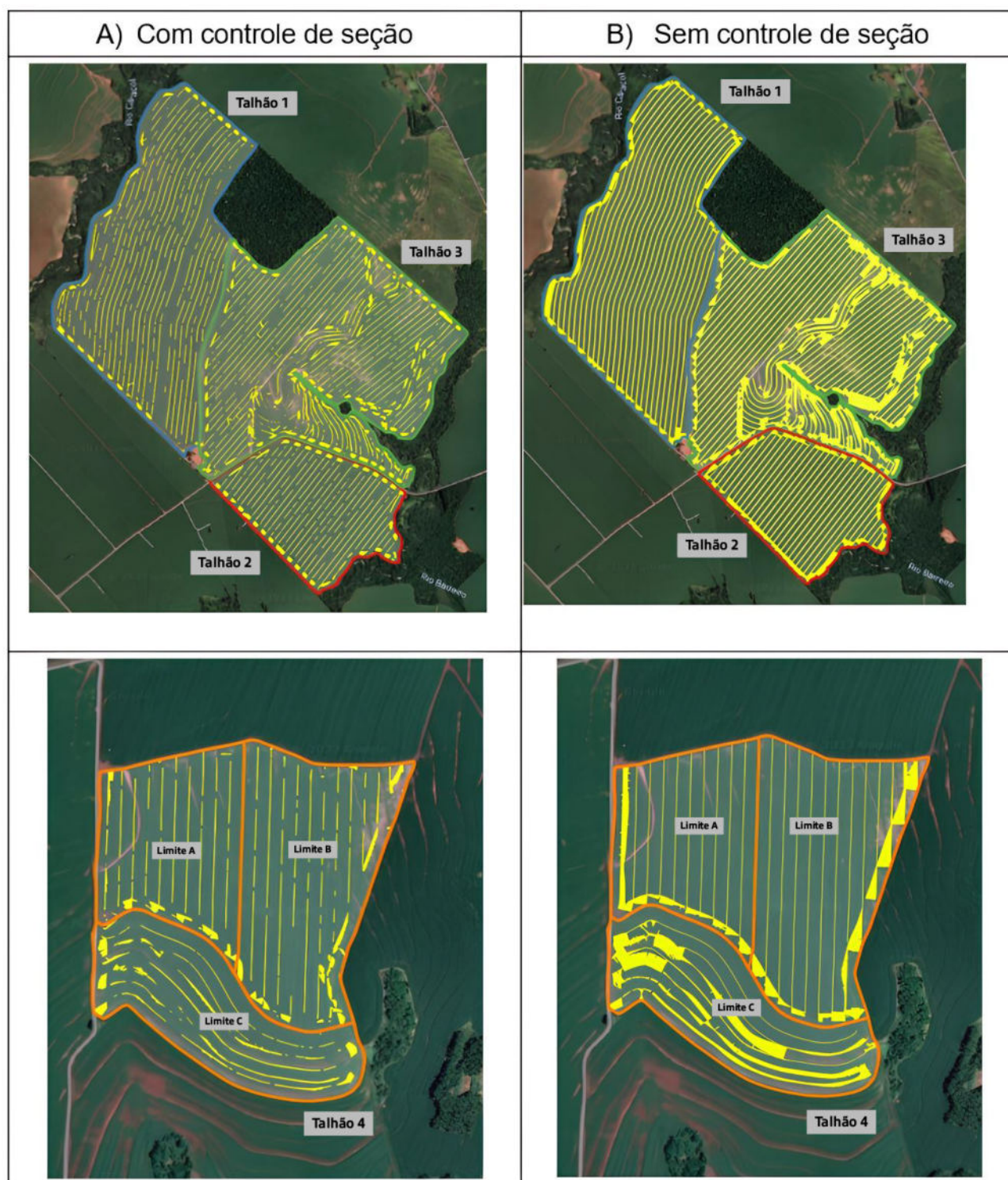
Figura 5. Mapas de sobreposição do fertilizante em situações de controle (A) e sem controle (B) do corte de seções.
