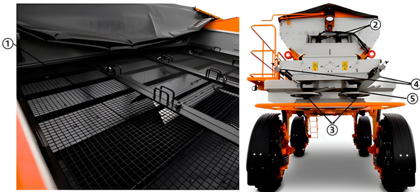
Figura 1. Componentes mecânicos de um distribuidor de corretivos e fertilizantes com disco duplo (3), mecanismo dosador volumétrico do tipo esteira transportadora (1), comporta raspadora dupla (2), atuador do ponto de queda (4) e de bordadura (5).
