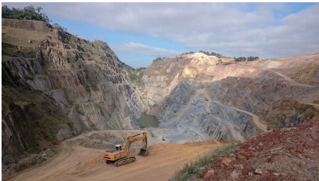
Figura 4. Vista geral da mina Vau Novo (Corte S-N) - Foliação principal ( S_0//S_n ) bem marcada no lado esquerdo, com mergulho para norte.
