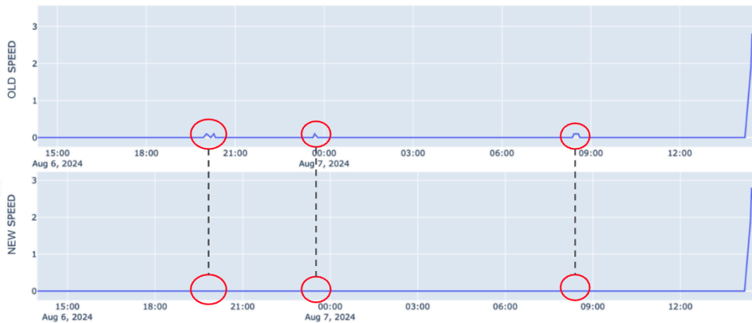
Figura 5 - Perfil de velocidade do STAR CRIMSON antes e após a aplicação do algoritmo 2
