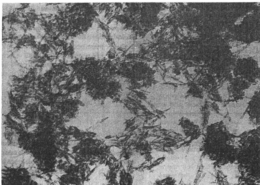
Fig. 2 — Micrografia eletrônica (100 000x) da criptomelana sintética S-3.
