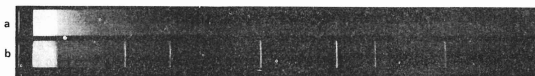
Fig. 1 — Diagramas de raios X com raia características de criptomelana: a - S-3; b - padrão.
