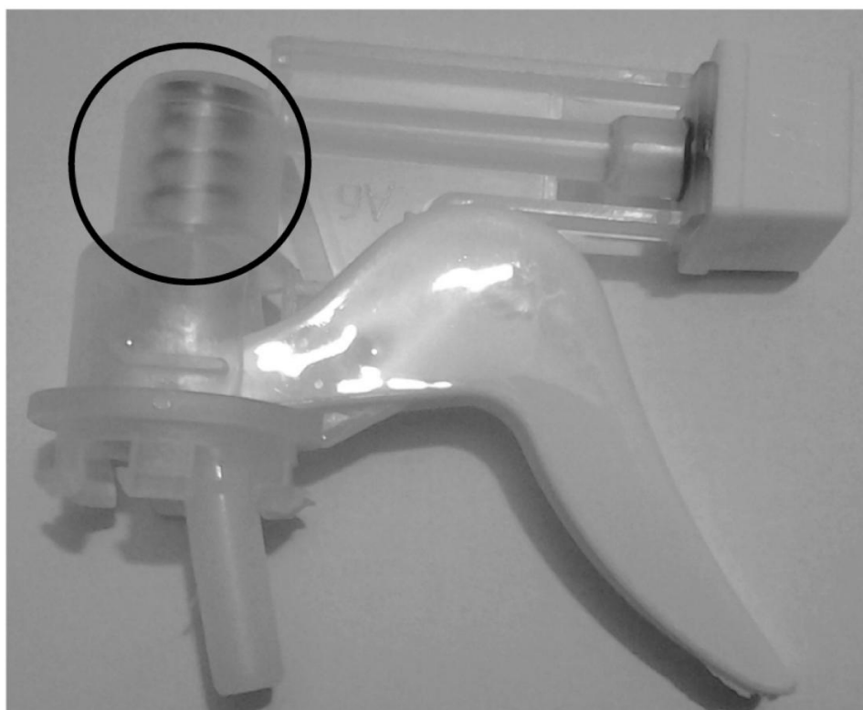
(c) A parte superior da válvula sem a capa.
