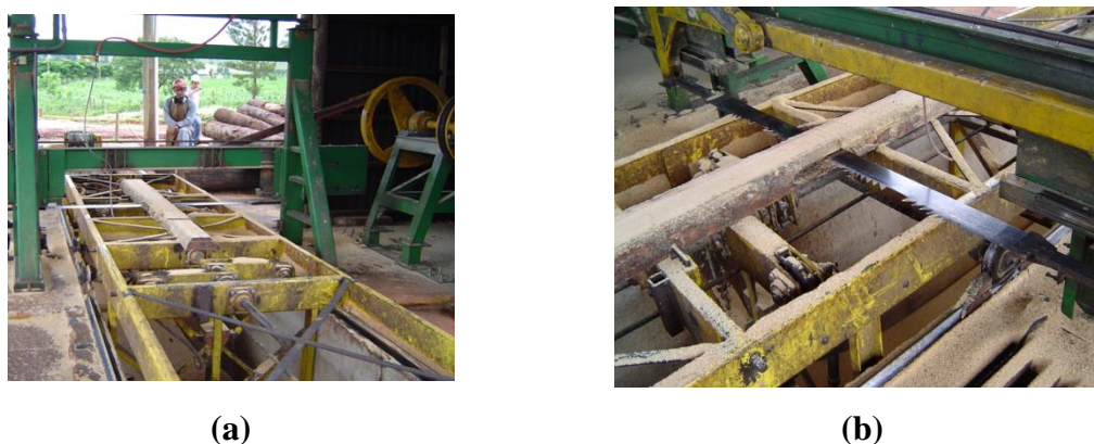
Figura 2: (a) Serra de desdobro primário de tora na serra Pica-Pau; (b) Tora de Eucalyptus sendo processada pela máquina Pica-Pau
