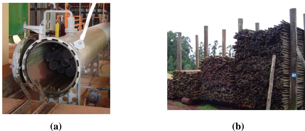
Figura 1: (a) Toras de madeira em processo de tratamento em auto-clave; (b) Tora de Eucalyptus tratadas
