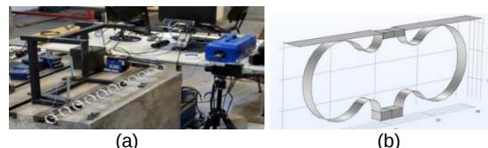
Figura 3. (a) Experimento dos ressonadores lineares acoplados a metaestrutura e (b) Modelo COMSOL do ressonador não linear
