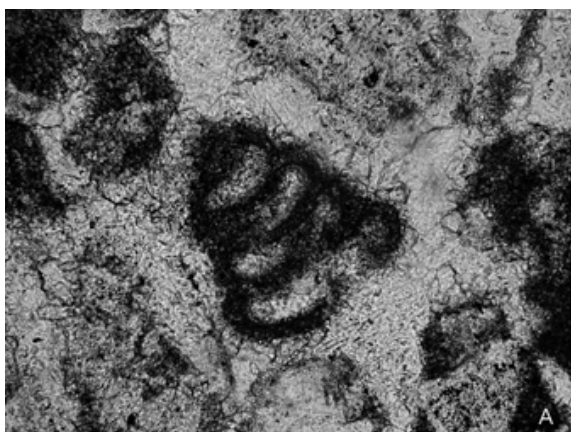
Figura 5 - Fotomicrografias do calcário fossilífero constituente do Anhanguera. (A) Foraminífero. Aumento: 40x. (B) Molusco na porção central. Aumento: 20x.
