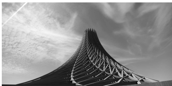
Figura 2: Imagem renderizada a partir da implementação do algoritmo da Figura 1, estabelecendo superfície regrada, produzida pelo bolsista.
