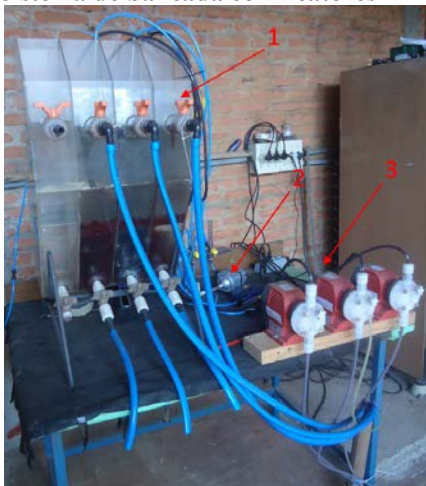
Figura 2 – Sistema de bancada com reatores MBBR aeróbio.
