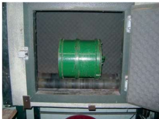
Figura 1 Equipamento utilizado nos ensaios de escrubagem em escala de laboratório.
