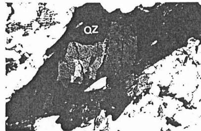
FOTO 6: Cristal de quartzo (Qz) deformado e fraturado em granito milonitizado do concreto da barragem de Pedras(BA) (25) . Observa-se, em nicóis cruzados, a extinção ondulante do quartzo deformado. Imagem obtida por microscopia de luz transmitida polarizada.
