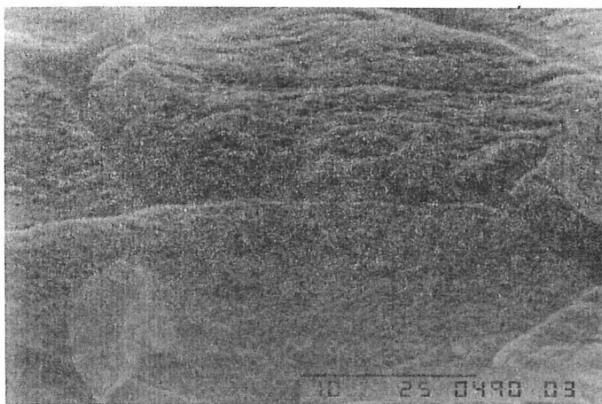
FOTO 3- Detalhe da Foto 2, observando cristais de belita poligonal com estruturas de crescimento (Aum. 3500x)
