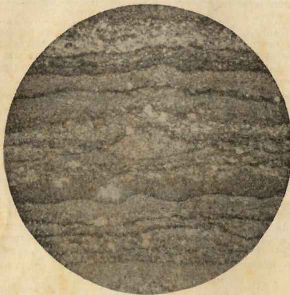
FOTOMICRO 1 — Sedimento tufítico bem estratificado. Luz natural, \times 30 .
