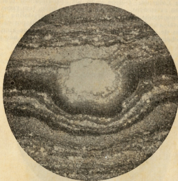
FOTOMICRO. 3 — Sedimento tuffítico mostrando apreciável contribuição de cinzas e poeiras vulcânicas. Percebe-se a depressão causada pela queda de um grão maior possivelmente projetado pelo vulcão. Luz natural, \times 30 .
