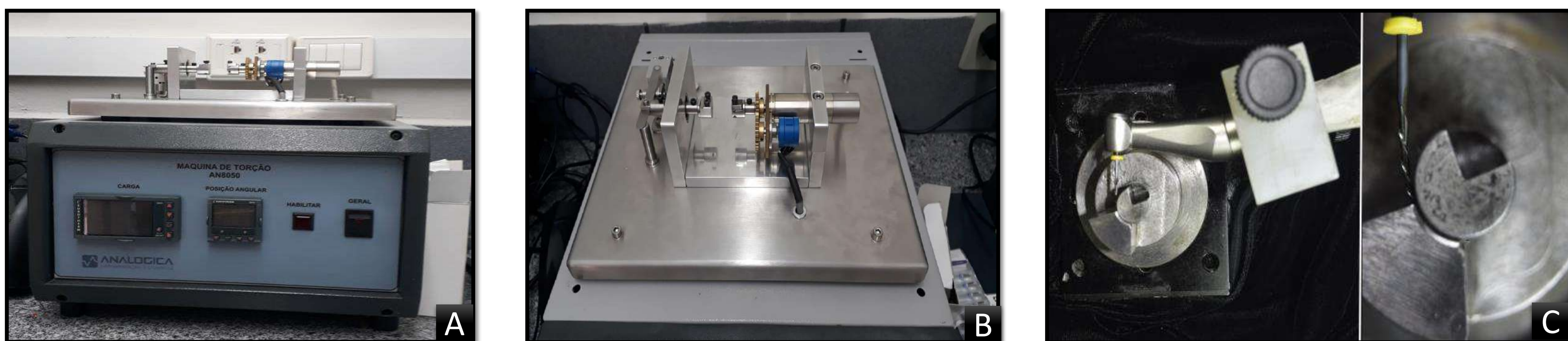
Figura 3. Imagens referentes aos equipamentos utilizados para obtenção dos dados relacionados a fadiga torcional e cíclica. A: Máquina de fadiga torcional; B: Vista superior da máquina de fadiga torcional; C: Vista superior do aparato de fadiga cíclica.
