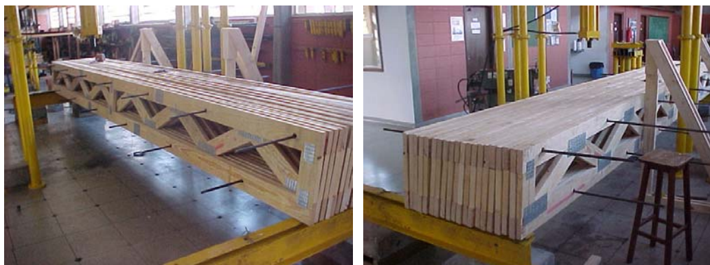
Figura 18 - Montagem por justaposição das treliças e espaçadores.
