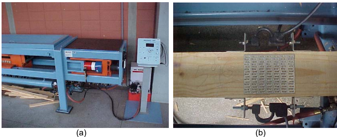
Figura 14 - (a) Máquina de tração em peças estruturais (b) Esquema do ensaio realizado.
