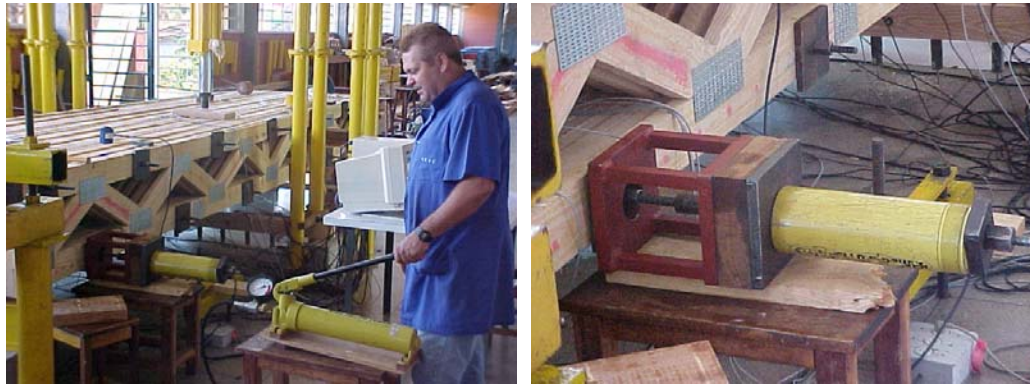
Figura 19 - Aplicação de protensão no protótipo através de bomba manual.
