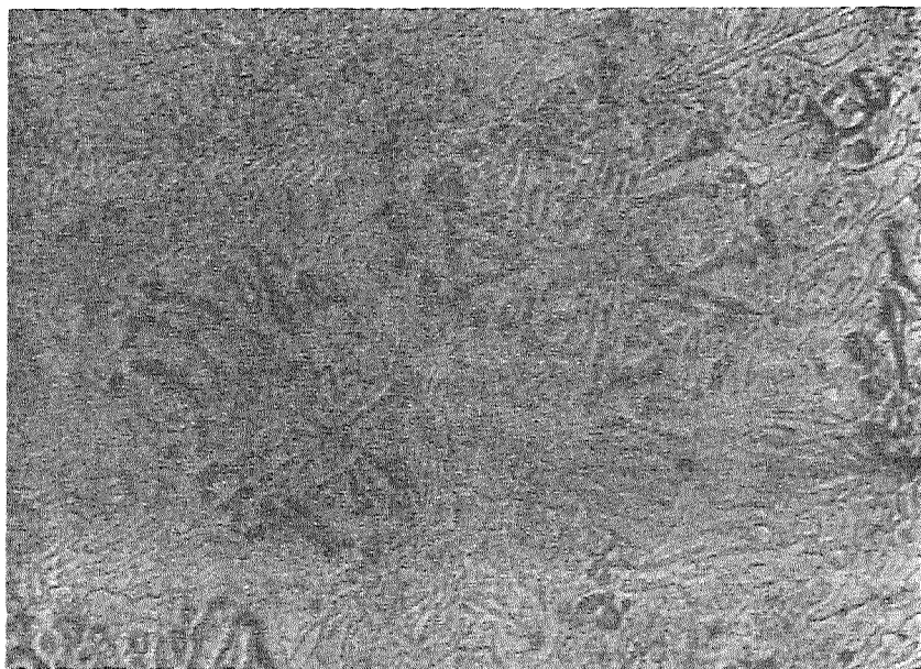
Figura 2. F.F. submetido ao T.T. nº 5. Presença de carbonetos de Nb com morfologia esquelética (escuras), carbonetos eutéticos (mais claros) e matriz martensítica com precipitação de carbonetos secundários. Ataque: 5% HNO_3 em metanol. Aumento Total = 330X
