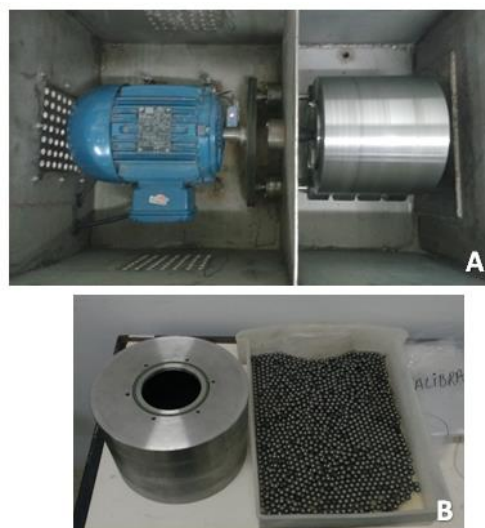
Figura 3. (A) Equipamento do ensaio de desgaste Micro-Deval: motor de acionamento (esquerda) e cilindro (direita); (B) Cilindro e a carga abrasiva (esferas com diâmetro de 9,5mm) utilizada no ensaio. Laboratório de Engenharia Civil (LECIV) da UENF-Campos dos Goytacazes/RJ.
