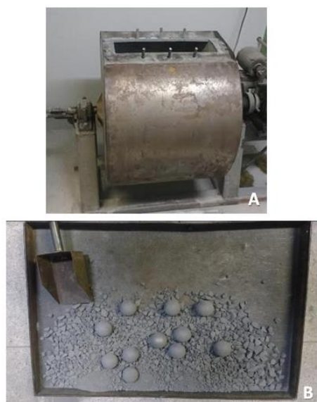
Figura 2. (A) Equipamento do ensaio de Abrasão Los Angeles; (B) Bandeja com a carga abrasiva (esferas de
