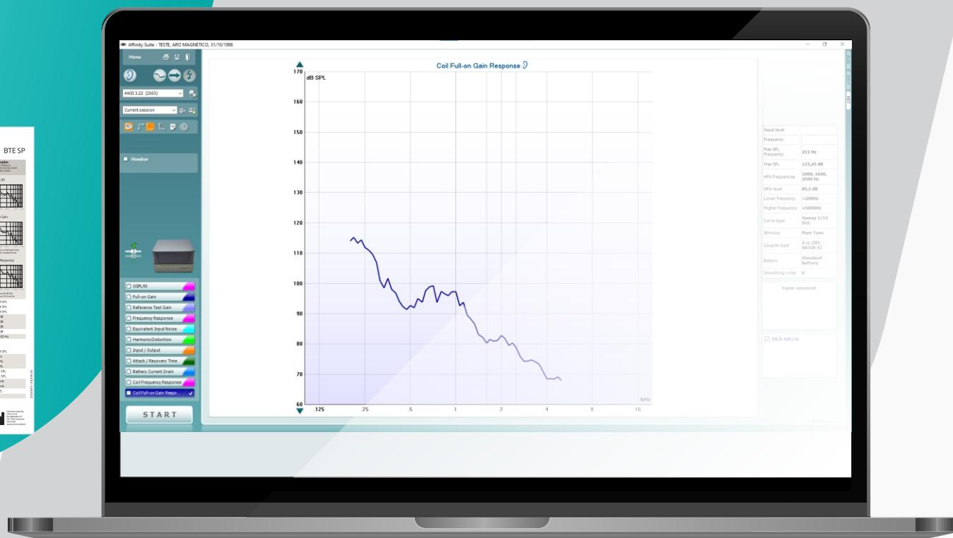
Verifique o valor de saída da bobina telefônica e compare com o valor indicado na coluna "Acoplador 2CC" da ficha técnica do fabricante. O intervalo aceitável de diferença entre os valores é de  $\pm 6$  dB.
