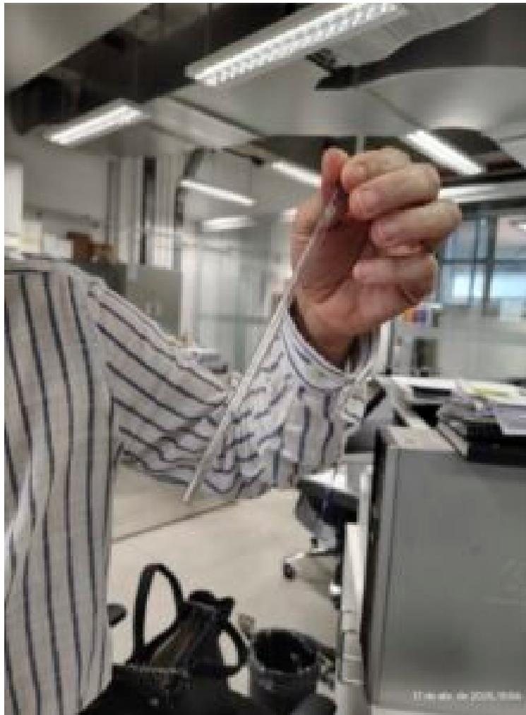
Figura 2. As amostras são colocadas em tubos como esse (ou menores) e inseridas no topo do Espectrômetro de Ressonância Magnética (Foto: Bianca Bosso)
