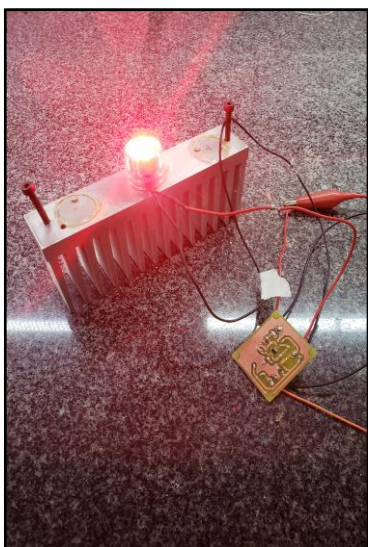
Figura 1: LED vermelho de alta potência em funcionamento
