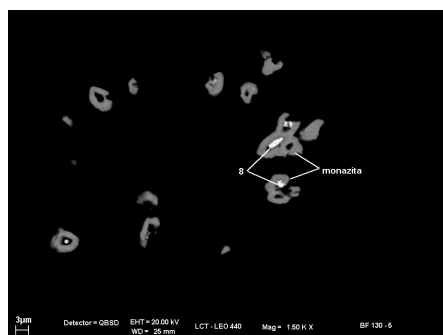
Foto 2 – Detalhe de nodulação de óxi-hidróxidos de ferro com Cu associado
