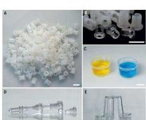
**Figura-4:** A e B – Mais de 200 peças (~brancas) feitas por moldagem por injeção. Elas foram produzidas a uma velocidade de 1 peça a cada 5 segundos. Após sinterizadas, elas se tornam vidros transparentes. C, D e E – exemplos de estruturas macroscópicas complexas construídas pelo processo de moldagem por injeção (barras de escala – 10 mm) (Crédito: Mader M. et al. 4)
