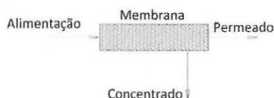
FIGURA 17.21 Esquema da separação por membranas.
