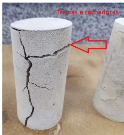
Figura 2: Trincas e rachaduras após 28 dias de CPs fabricados com NaOH 10Mol/L em água.
