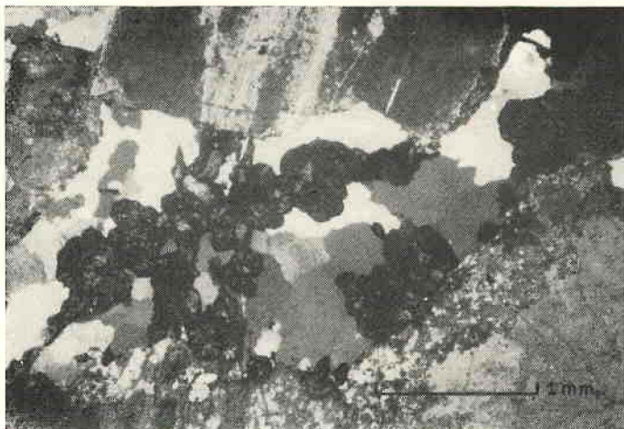
Fig. 8 — Lâmina 6. Nicois a 45°. Granito fenitizado. Em cima e em baixo dominam feldspatos. No centro, uma larga faixa de agregado de quartzo. Dentro dêste, e nos contatos com o feldspato de baixo, desenvolvem-se corpos arredondados constituídos de agregados fibrosos de anfibólio sódico. Ainda entre a zona anfifólico-quartzosa e o feldspato inferior formou-se agregado de ortoclásio secundário.
