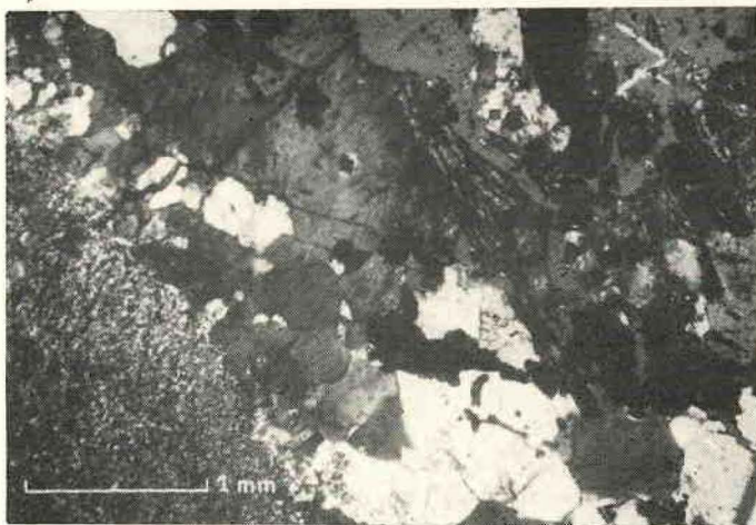
Fig. 10 — Lâmina 9. Nicóis a 45°. Sienito. Em baixo à esquerda um grande feldspato potássico de origem granítica, totalmente alterado e franjado por agregados de soda-ortoclásio muito mais límpido. O restante da foto mostra feldspatos e egrinaugita.
