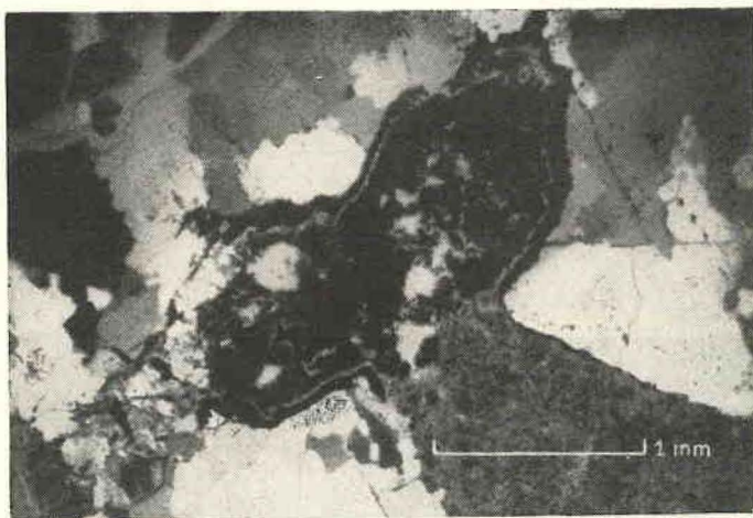
Fig. 7 — Lâmina 34. Nicóis a 45^\circ . Granito fenitizado. Fase avançada de transformação da biotita (corpo no centro da foto). O mineral está totalmente fragmentado e associado a ortoclásio secundário, clorita, calcita e egrina. Externamente, separando-o dos restantes minerais graníticos, observa-se uma auréola dupla, quase completa, de ortoclásio por dentro e egrina por fora.
