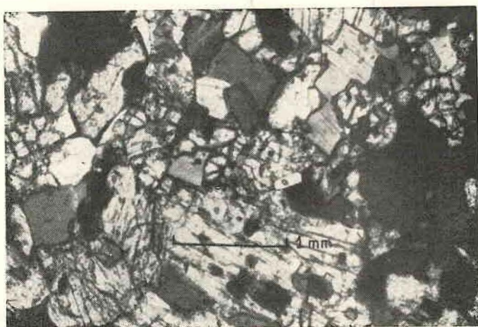
Fig. 15 — Lâmina 10. Nicóis descruzados. Biotita-piroxenito. Augita (alto relêvo, cinza claro) e biotita (diversos tons de cinza a preto) com alguma apatita (branco) e magnetita (preto).
