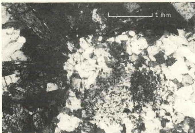
Fig. 12 — Lâmina 40. Nicóis a 45°. Shonkinito. A metade inferior direita da foto mostra restos turvos incompletamente transformados de um feldspato de origem granítica. Acha-se rodeado de soda-ortoclásio límpido, que se desenvolveu a sua custa. O restante da foto mostra agregado de egrinaugita e ortoclásio.
