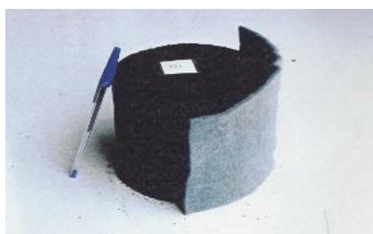
Figura 1a) Corpo de prova sendo envolto pelo geotêxtil
