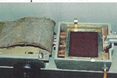
Figura 1j) Primeira metade de solo posicionada na caixa
