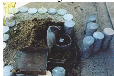
Figura 1h) Corpo de prova sendo desenterrado
