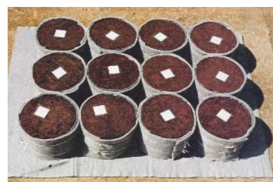
Figura 1d) Corpos de prova sobre a manta geotêxtil
