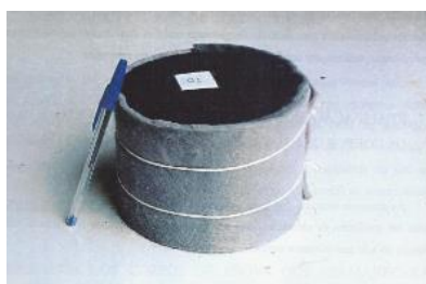
Figura 1b) Corpo de prova envolto pelo geotêxtil
