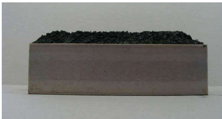
Figura 6 – Modelo de vagão com carga de minério PXBR (teor de umidade = 11%, velocidade = 19,4 m/s; tempo = 0 min).
