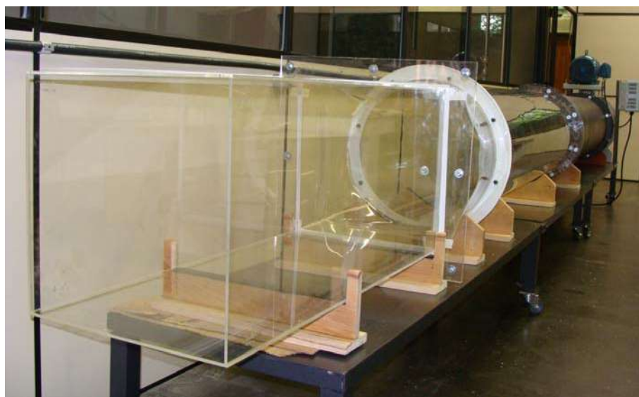
Figura 2 – unidade experimental de túnel de vento da THX.
