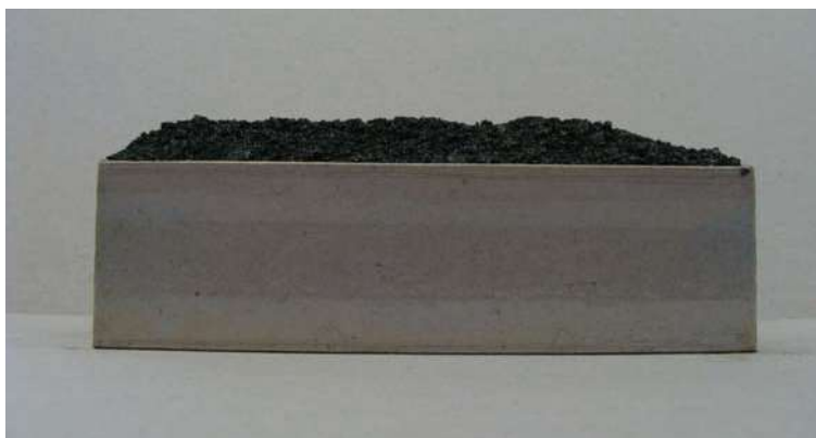
Figura 7 – Modelo de vagão com carga de minério PXBR (teor de umidade = 11%, velocidade = 19,4 m/s; tempo = 90 min).
