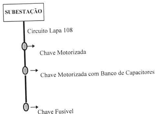
Fig. 6-9 - Esquema dos postos de telecomando
