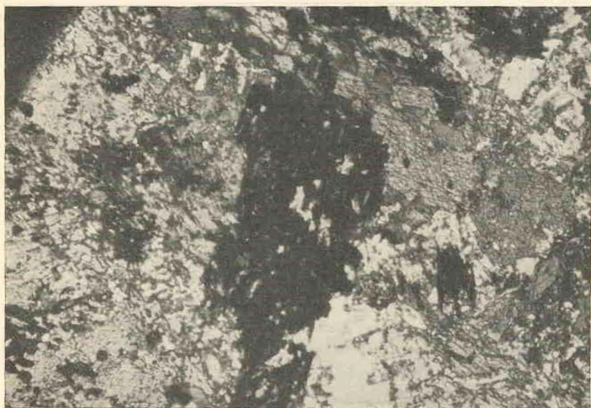
Fotomicrografia n.º 8 — Cristal de hornblenda exibindo estrutura poiquiloblástica. As inclusões são de quartzo e feldspato. Nicóis X, X 45.
