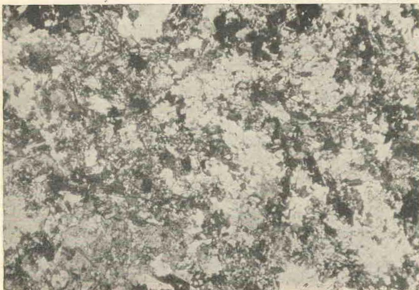
Fotomicrografia n.º 7 — Plagioclásio mostrando forma granulada. Nicóis X, X 160.
