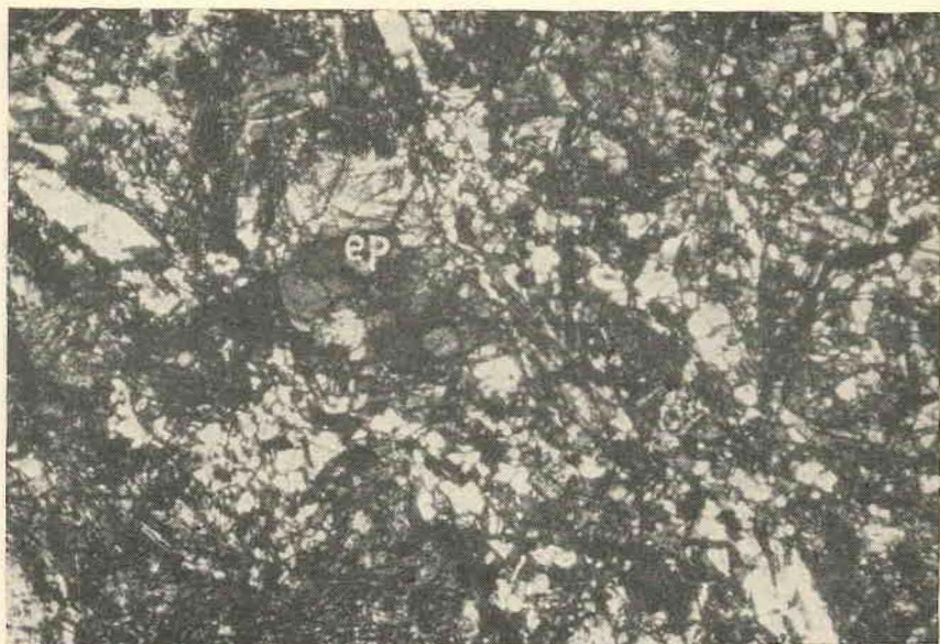
Fotomicrografia n.º 5 — Observa-se grande cristal de epídoto no interior de massa feldspática, sugerindo a sua derivação a partir desse mineral. Notar também, a forma granulada do plagioclásio. Nicóis X, X 55.
