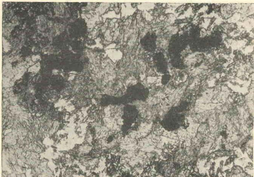
Fotomicrografia n.º 1 — Anfibolito exibindo textura granoblástica, granulação grossa. Na parte central notam-se manchas de mineral opaco. Nicóis X, X 40.
