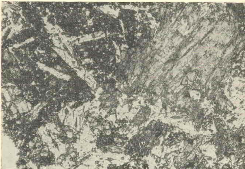
Fotomicrografia n.º 9 — Porfiroblasto de hornblenda ocupando o canto direito, superior, da foto. Observa-se também, o plagioclásio ripiforme, evidenciando estrutura blastofítica. Nicóis //, X 40.
