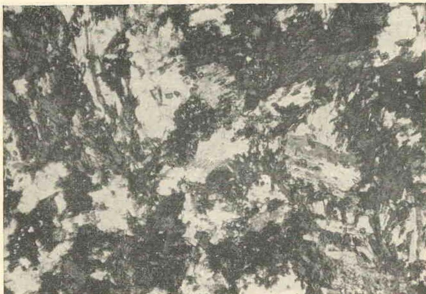
Fotomicrografia n.º 11 — Anfibolito de estrutura blastofítica. Nicóis X, X 30.
