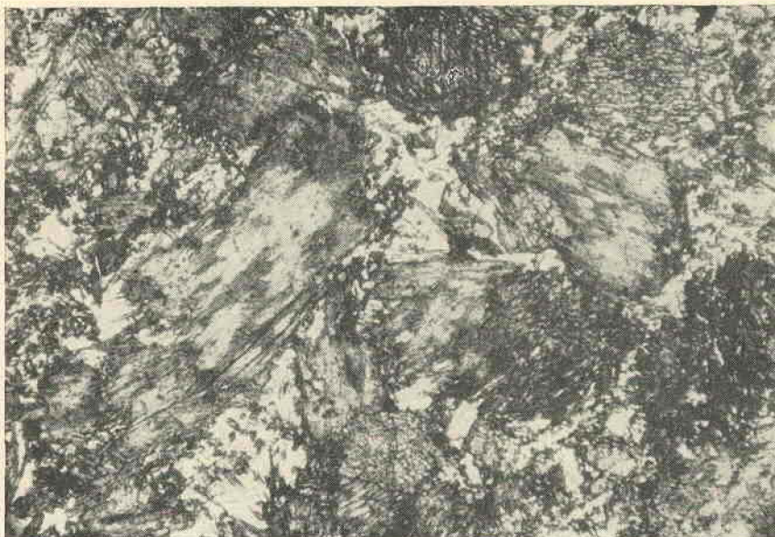
Fotomicrografia n.º 3 — Cristais de hornblenda exibindo manchas mais claras em seu interior. Nicóis //, X 40.
