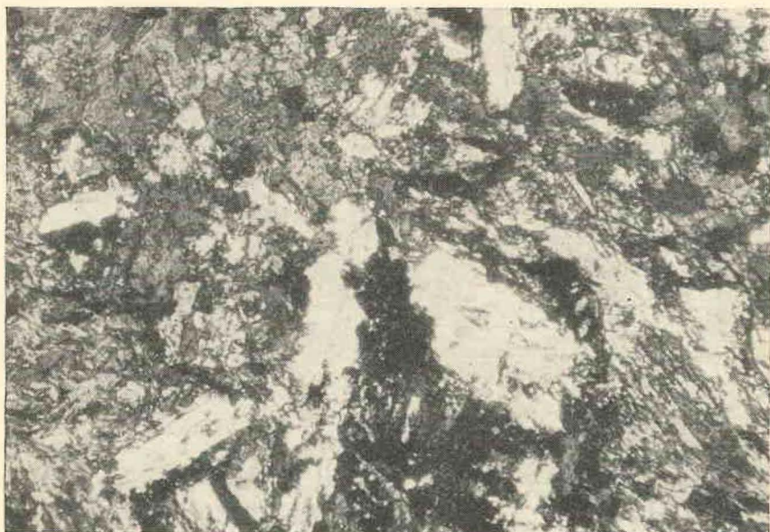
Fotomicrografia n.º 12 — Anfibolito de estrutura blastofítica. A secção é praticamente a mesma da foto anterior. Nicóis X, X 30.
