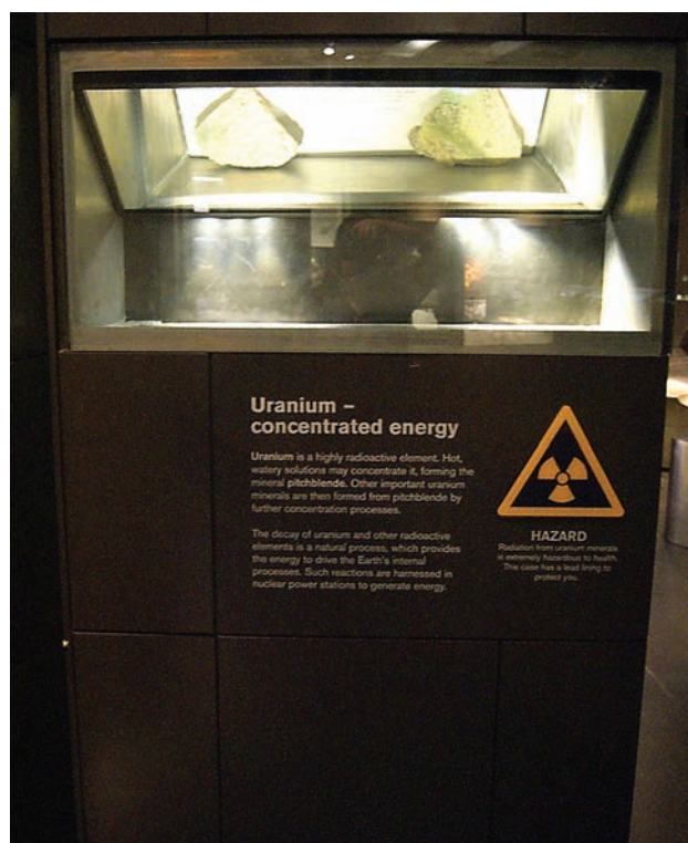
Figura 51. Vitrina especial para exibição de minerais radioativos. Nota-se que o visitante não tem sequer contato visual com as amostras, apenas com suas imagens. Notar também o posicionamento de aviso de radiação em local visível. Acervo: London Natural History Museum.
