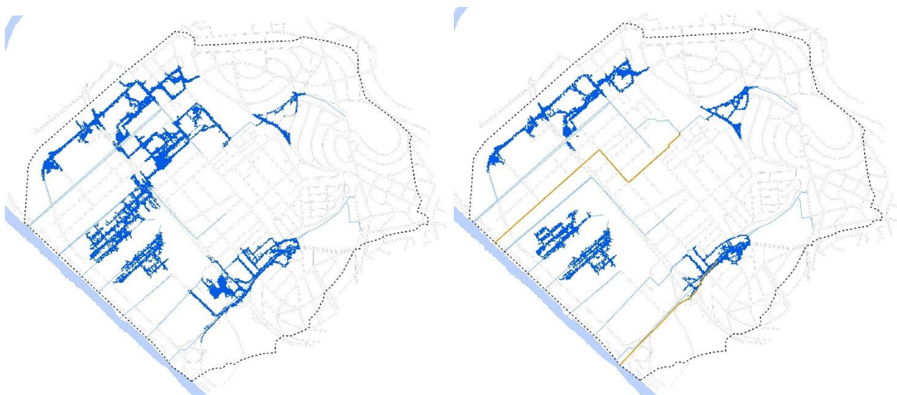
Figura 5: Manchas simuladas para condição de Tr 5 anos e nível do Rio Pinheiros normal: rede atual (esquerda); condutos forçados nos dois córregos principais (esquerda)
