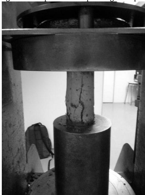
Figura 5 - Corpo de Prova que atingiu a ruptura
