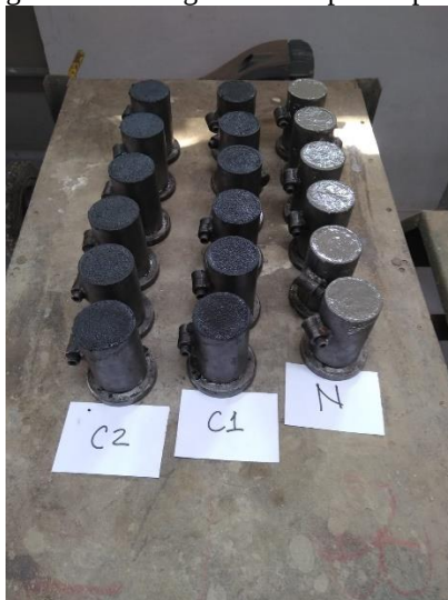
Figura 3 - Moldagem dos corpos de prova
