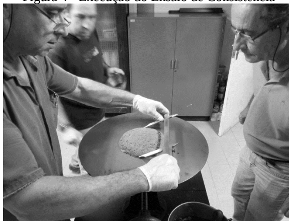
Figura 4 - Execução do Ensaio de Consistência
