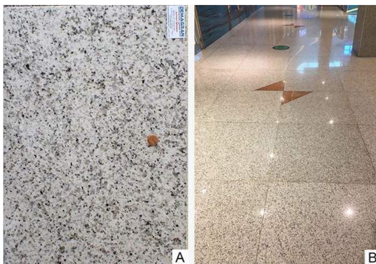
FIGURA 7.9: A. Granito Branco Ceará. B. Placa polida revestindo o piso e as colunas do Shopping RioMar em Fortaleza (CE).
