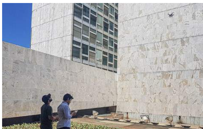
FIGURA 13.20: Levantamento fotográfico por meio de VANT na empena Noroeste da torre Sul do Congresso Nacional.
