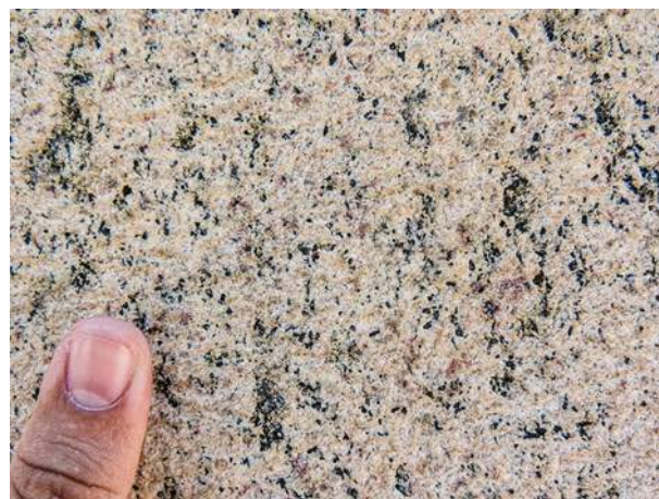
FIGURA 8.12: Detalhe do Granito Macaíba, destaque para alinhamento dos cristais de anfibólio.
