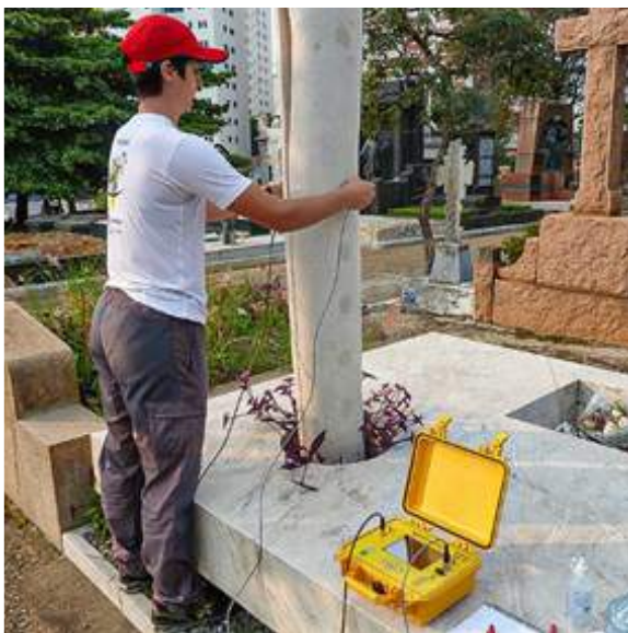
FIGURA 20.6: Equipamento para medir velocidade de ondas longitudinais ultrassônicas.
