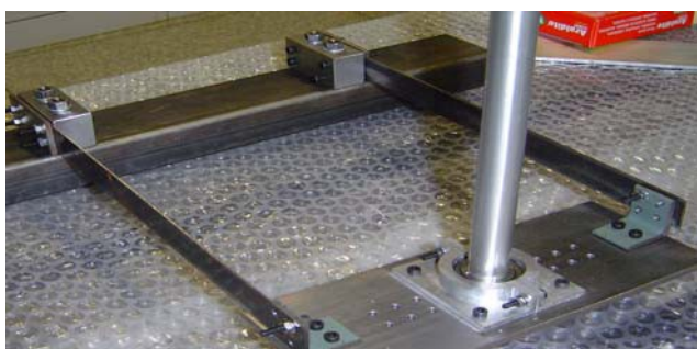
Figura 4. Detalhes do dispositivo de flexão
