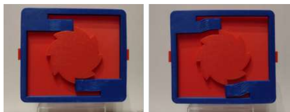
Figura 2: Mecanismo com sistema de catraca antes da flexão (esquerda) e em flexão (direita) que só permite a rotação horária (próprio autor).
