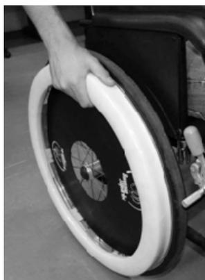
Figura 6. Imagem final de uma cadeira de rodas com o aro ergonômico.
