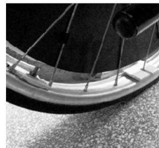
Figura 5. Instalação com parafuso e adaptação para encaixe das abas nos raios da roda.
