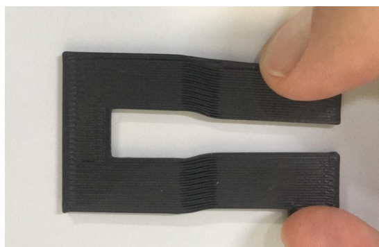
Figura 1: Peça impressa usando o código proposto com variação de fluxo. (Próprio autor, 2021)
