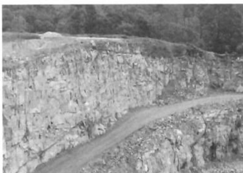
1) Decapeamento: remove a cobertura de vegetação, de solo e rocha alterada (estéril) presente no afloramento rochoso.
