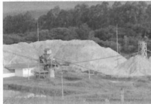
2) Desaguamento e classificação: a polpa de areia é bombeada até uma peneira, ocorrendo desaguamento e separação do cascalho. Ciclones separam a areia em outras faixas granulométricas.
