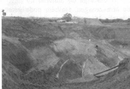
1) Desmorte hidráulico: desagregação com água de maciços contendo rochas sedimentares e planícies fluviais.
