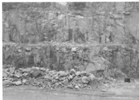
2) Desmonte e carregamento: perfuração dos maciços rochosos, desmonte das bancadas com explosivos e pré-fragmentação (rompedores hidráulicos acoplados a escavadeiras).
