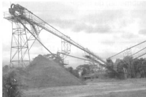
2) Desaguamento e classificação: a polpa de areia é bombeada até a peneira, ocorrendo desaguamento e separação do cascalho (> 4,8 mm). Ciclones separam a areia em outras faixas granulométricas (grossa, média, fina).
