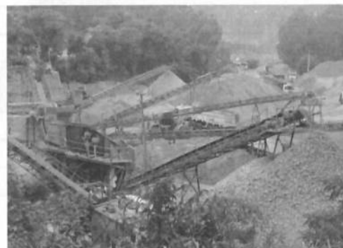
4) Britagem e peneiramento: sequência de britadores (três estágios) e peneiradores (dois), de forma a se obter os tipos de agregados britados (rachão, brita, brita graduada e areia).
