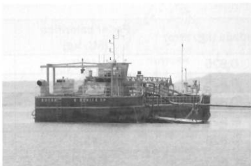
1) Dragagem: usada para a sucção da areia do leito do rio (cava submersa).
