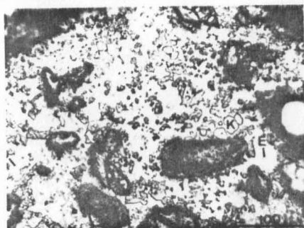
FOTO 3: Cristais de alita (A) xenomórficos e pouco desenvolvidos associados à fase intersticial (D e E) abundante e à cal livre (K). Microscopia de luz refletida.
