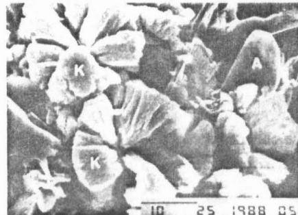
FOTO 20: Aspecto sob microscópio eletrônico de varredura de cristais de cal livre (K), já parcialmente hidratados. A morfologia arredondada é substituída por formas em couve-flor , indicando processo expansivo. Observa-se cristal de C_3S (A).
