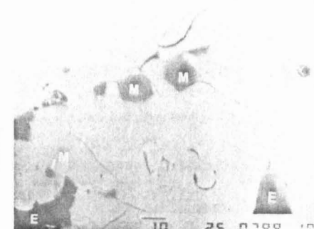
FOTO 28: Cristais idiomórficos (hexagonais) de periclásio (M) dispersos na fase intersticial e incluídos na alita (A), observados por microscopia eletrônica de varredura (elétrons retroespalhados). E = C 3 A
