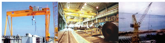
Figura 3: Exemplos de pórtico (esq), ponte rolante e guindaste do tipo lança (dir)
